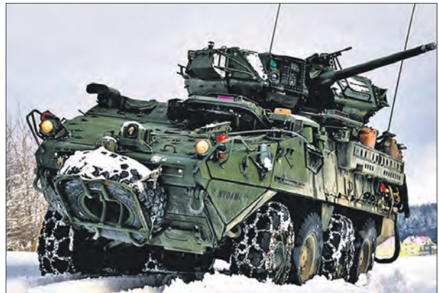
Боевая машина пехоты M1296 «Драгун» с дистанционно управляемым модулем вооружения
