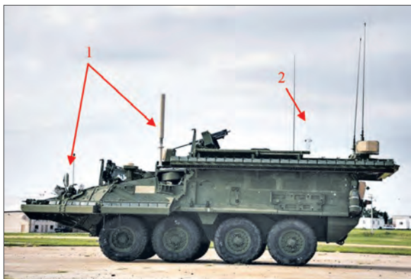
Бронетранспортер «Страйкер» с САЗ «Айрон Кётн»: 1 – пусковые установки противозаряда; 2 – радиолокационная станция обнаружения целей
