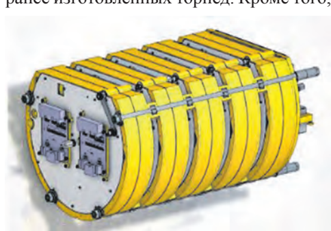
Модуль аккумуляторных батарей
