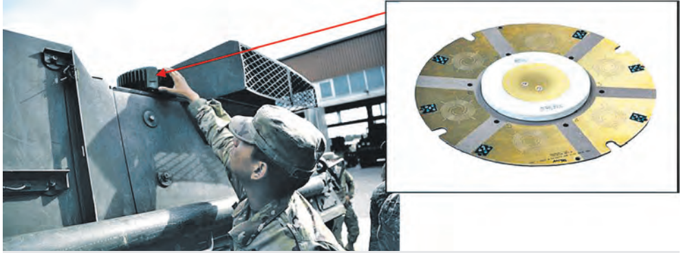
Помехозащищенная приемная антенна КРНС «Навстар»
