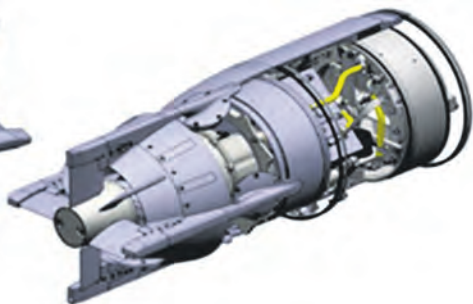
Модуль с блоком управления электродвигателем и катушкой телеуправления
