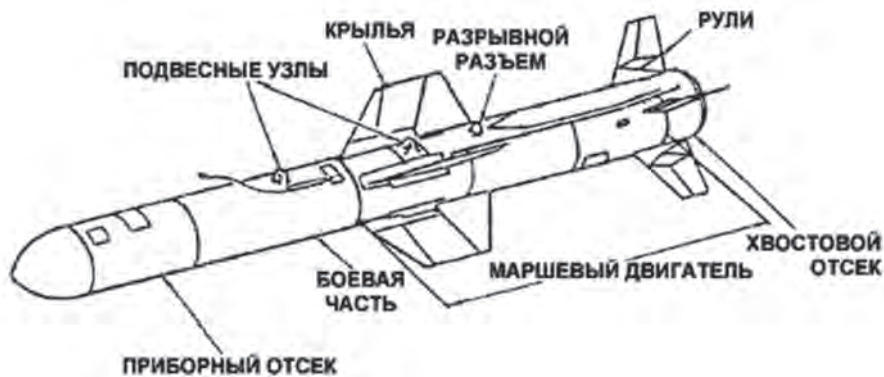
Основные элементы конструкции противокорабельной ракеты AGM-84A «Гарпун»
