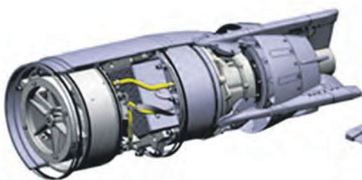
Модуль с блоком управления электродвигателем и катушкой телеуправления
