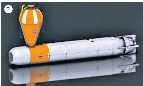
Практический модуль торпеды TS47: 1 – вид в разрезе; 2 – воздушный поплавок, обеспечивающий всплытие
